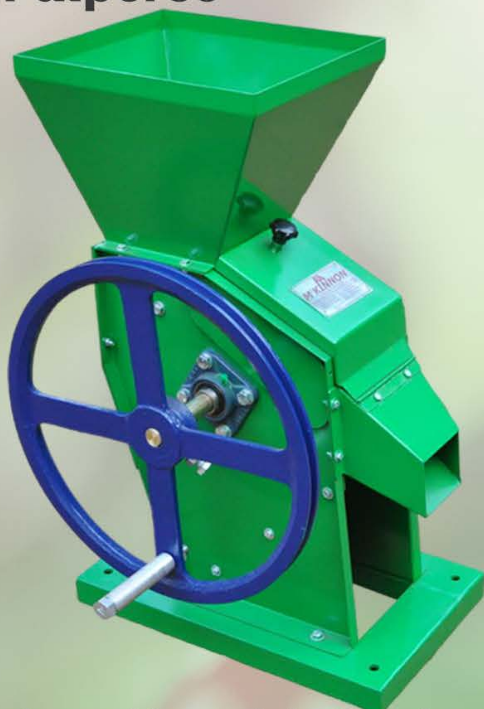
Pulpero Manual de Camisa - Capacidad sin motor 150 lbs/hora Capacidad con motor 800 lbs/hora
