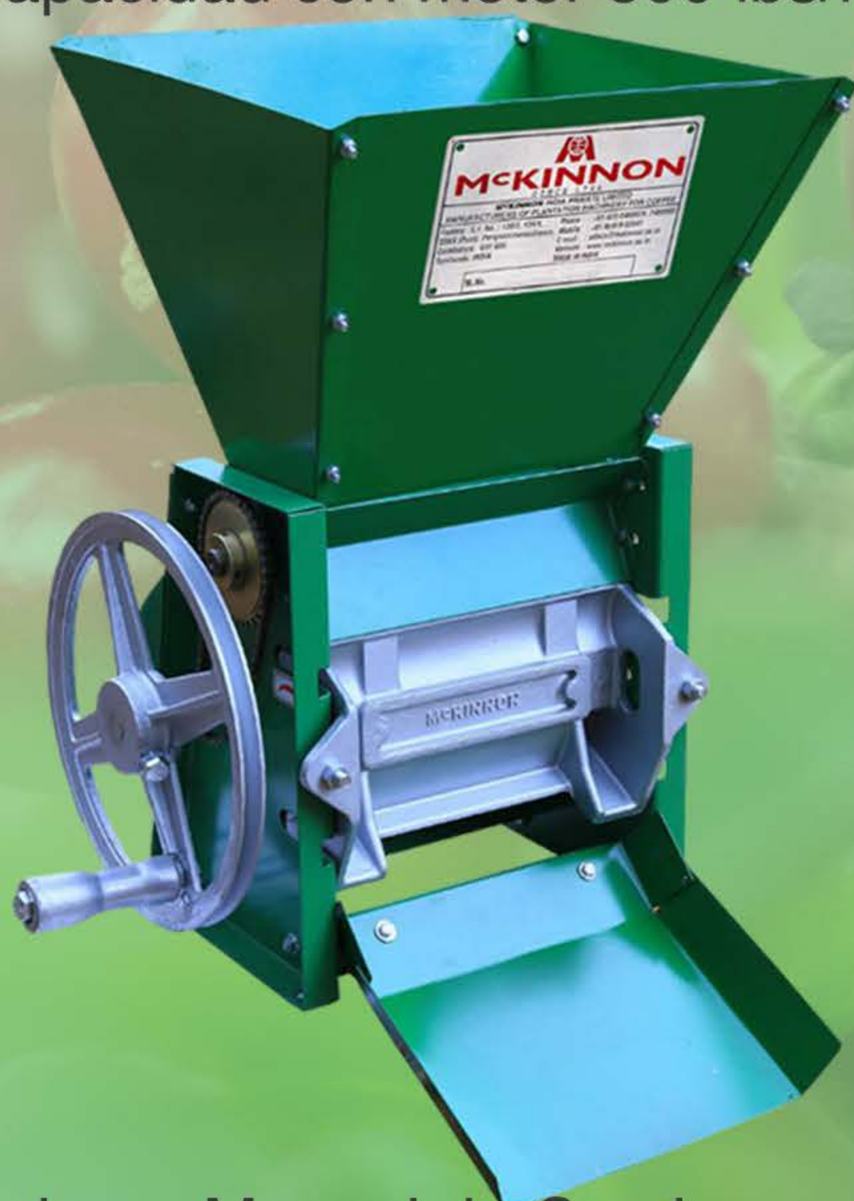
Pulpero Manual de Camisa - Capacidad sin motor 100 lbs/hora Capacidad con motor 400 - 500 lbs/hora
